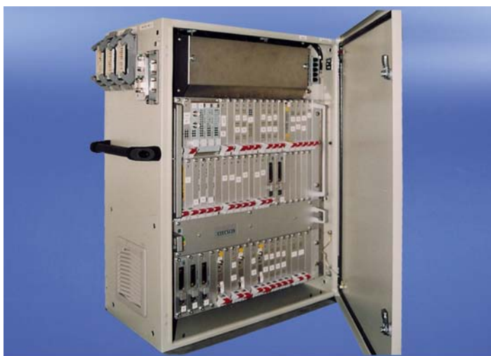
Электронный пост централизации
